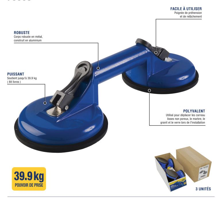
Lorsqu'il s'agit de déplacer des carreaux, des pierres, du marbre de culture et même du verre de grande taille lisses et non poreux, la double ventouse de QEP est imbattable. Elle dispose de ventouses non marquantes capables de tenir jusqu'à 88 livres et de poignées à levier surdimensionnées qui facilitent l'aspiration des surfaces.
