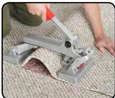
L'action de verrouillage unique permet d'effectuer des réparations sans l'utilisation des mains. Pour le braquage facile de motif, tourner le Mécanisme de Verrouillage Automatique à la position "ON" et la tête est verrouillée à chaque 1/4 po. de déplacement de la plaque d'aiguilles. Pour les étirements de tapis conventionnelles, tourner le mécanisme de verrouillage à la position "OFF" et le tendeur fonctionnera dans le mode anti verrouillage.
